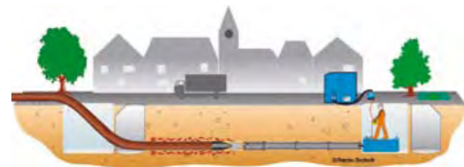
Verfahrensschema statisches Berstlining-Verfahren-Kurzrohreinzug aus Schächten
